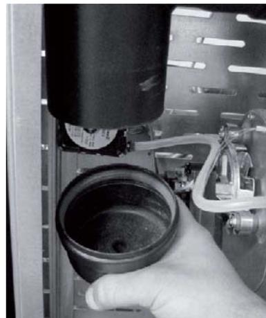
Remonter dans le sens inverse en prenant soins de vérifier le joint. du tampon.
