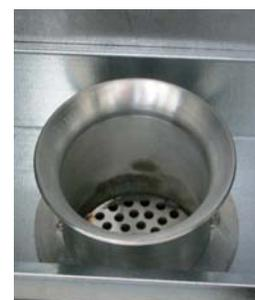
Démonter la plaque du dessous de la chambre de combustion à l'aide d'un tournevis et à l'aide d'un aspirateur, nettoyer dessous cette plaque.
