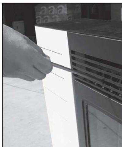
Actionner le grattoir 5-6 fois en tirant et poussant le levier pour garantir le nettoyage des échangeurs. Laisser le levier dehors pour faciliter le démontage des parois internes de la chambre de combustion.
